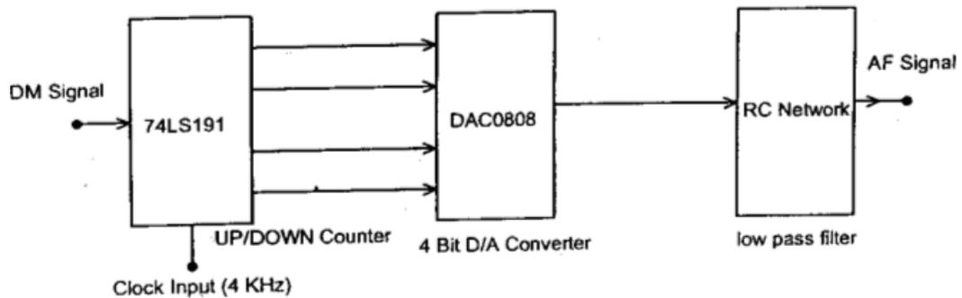
**Fig.4.2. DM Demodulator**
